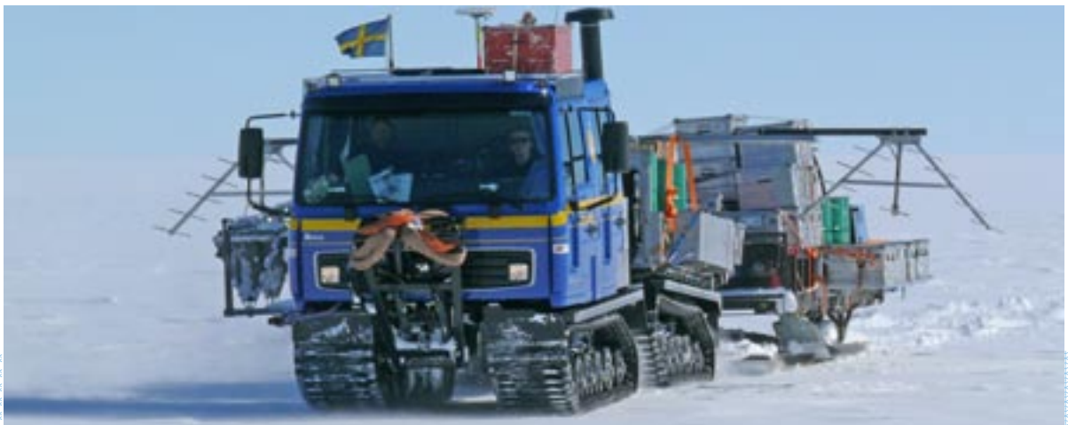
JASE – Japanese Swedish Antarctic Expedition kartlägger isstrukturer och subglacial topografi med hjälp av radarutrustning fäst på en bandvagn. Foto Per Holmlund
