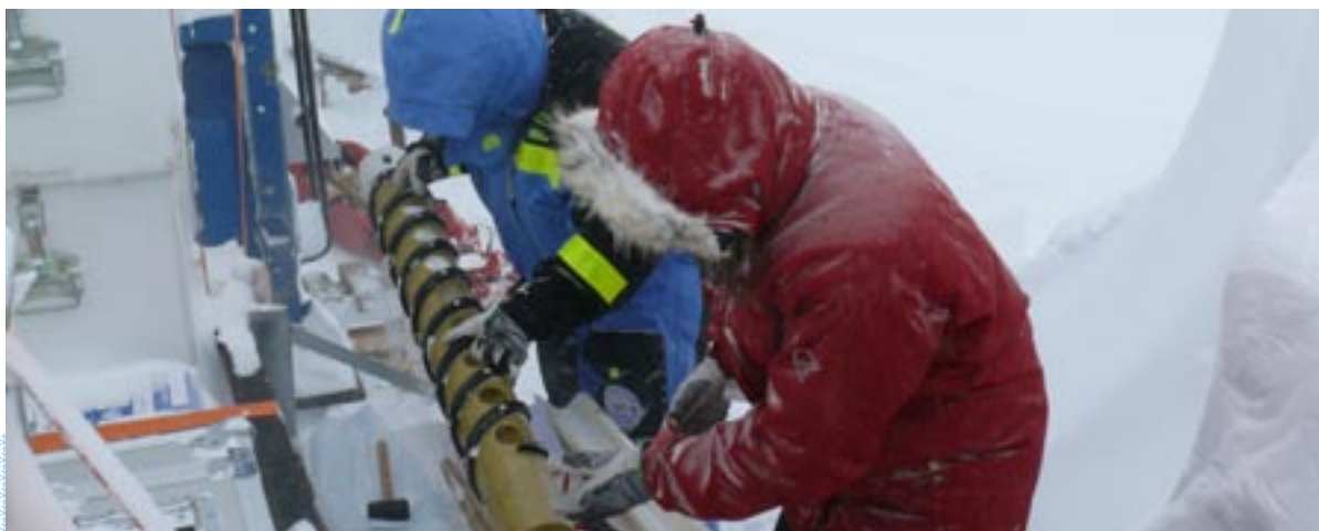
Snö borrar upp och tas hem för analys. Från kemisk sammansättning i varje års snölager kan luft- och nederbördsförhållanden rekonstrueras år för år. JASE, Antarktis 2007. Foto: Per Holmlund
