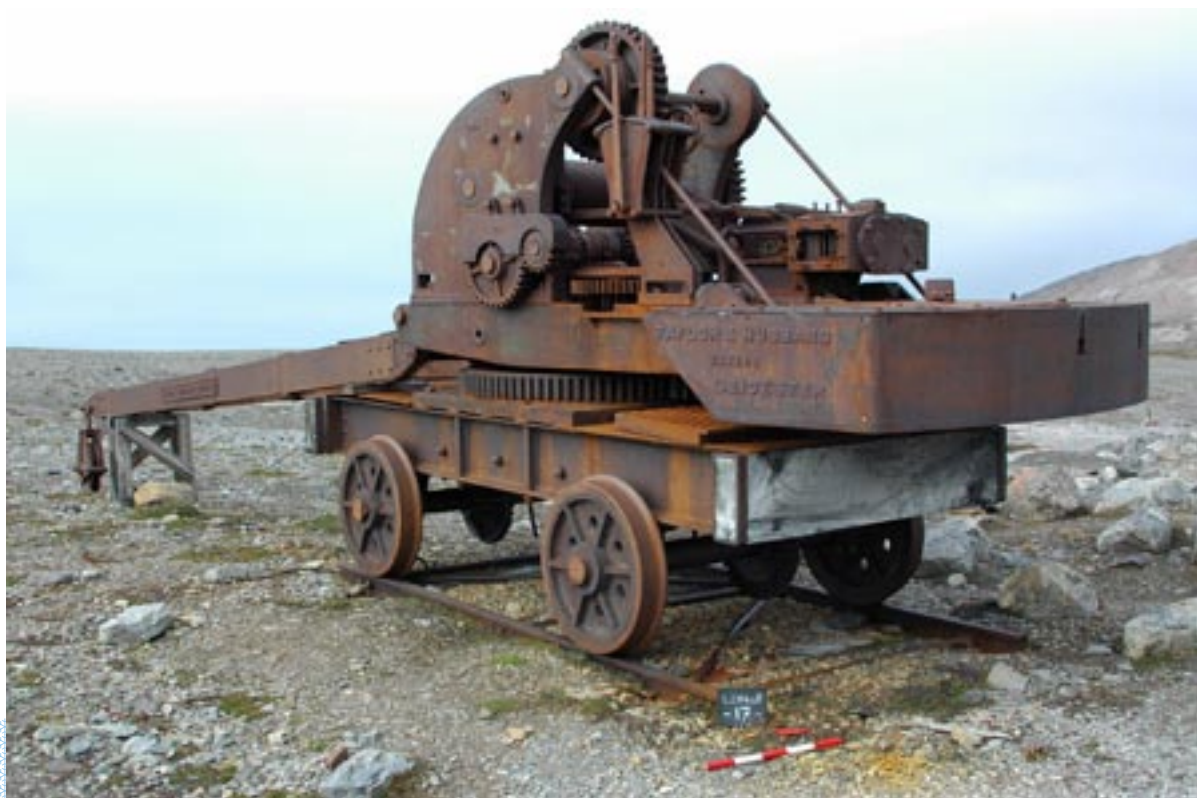
Channeler – brytningsmaskin för marmor – vid den övergivna bosättningen och marmorbrottet New London, Kongsfjorden, Svalbard. Anläggningen drevs av det brittiska gruvbolaget The Northern Exploration Company på 1910-talet och utgör en av de industrianläggningar som studeras inom ramen för LASHIPA projektet. Foto: Dag Avango
