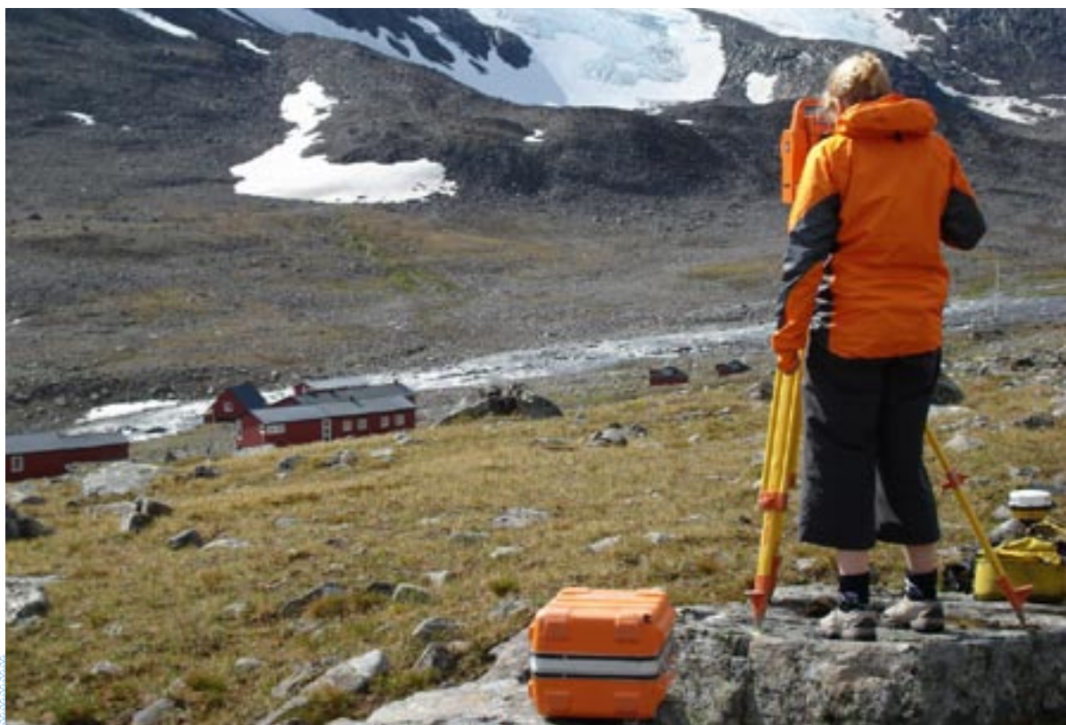
Doktorand i glaciologi Susanne Ingvander mäter in punkter i Tarfaladalen med avvägningsinstrument. Längst ner i dalen syns Tarfala forskningsstation. Foto: Gunhild Rosqvist
